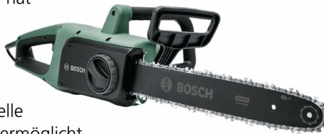
Dank eines großen, seitlich ausgerichteten Ölbehälters mit gut zugänglichem Verschluss ist ein einfaches Nachfüllen des automatisch arbeitenden Kettenschmiersystems garantiert. Mit einer stabilen Rückschlagbremse zum wirkungsvollen Stoppen der Kette ist für die erforderliche Sicherheit gesorgt. Diese Kettensäge ist leicht zu bedienen und zu bewegen und daher ideal zum Sägen von Baumstämmen, dicken Ästen und kleinen bis mittelgroßen Bäumen.
